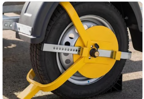
Verwenden Sie eine Radkralle, um Diebstahl und unbefugte Bewegungen zu verhindern.
