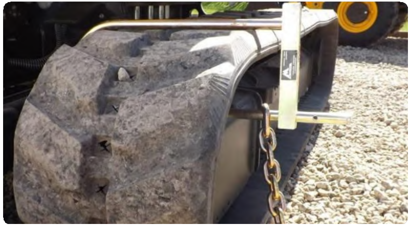
Hochwertige Schienensicherung – verhindert das Verschieben und den Diebstahl kleiner Schienenfahrzeuge
