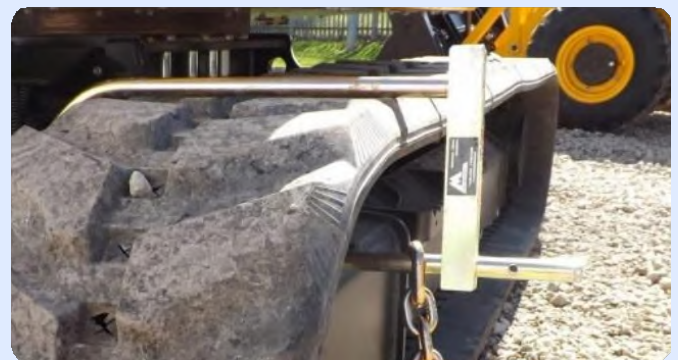
Hochbelastbare Spurverriegelung – verhindert das Bewegen und den Diebstahl kleiner Raupenmaschinen.
